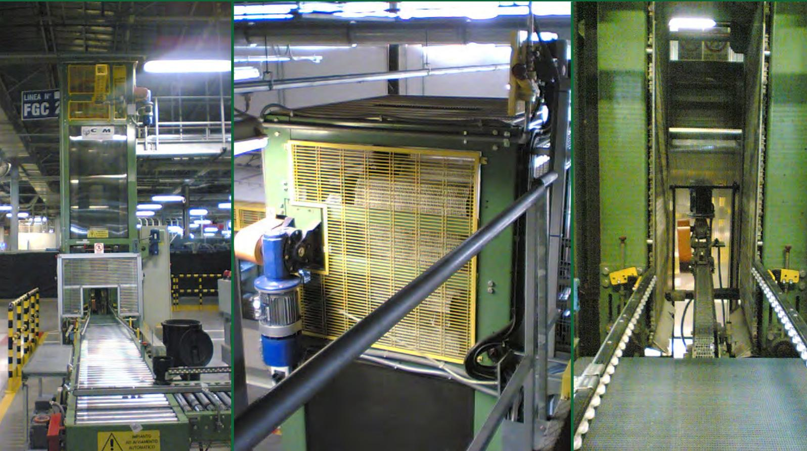
El elevador / discensor de estantes contrapuestos es un componente que permite aumentar o disminuir el flujo de productos dentro de una planta de producción con el fin de mejorar la logística interna. Es un transporte de movimiento continuo que sube o baja uno o más productos de forma simultánea. La construcción puede llevarse a cabo en acero pintado o de acero inoxidable o aluminio.
