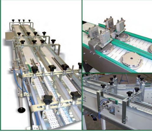
El acoplamiento motorizado a escalar es un tipo de transporte que se requiere para reunir dos flujos de productos que tienen una alta producción en un solo.
