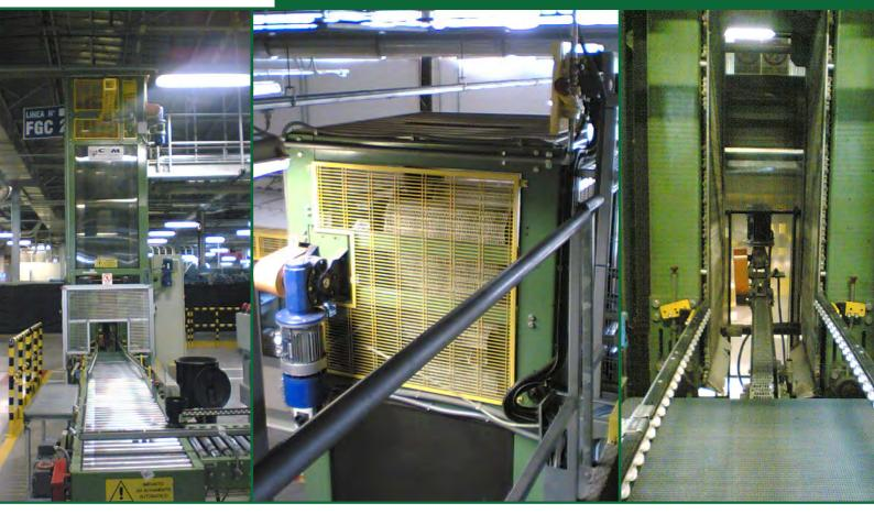
L'elevatore / discensore a ripiani contrapposti è un componente che permette di alzare o abbassare il flusso di prodotti all'interno di uno stabilimento produttivo al fine di migliorarne la logistica interna. E un trasporto a movimento continuo che solleva o abbassa uno o più prodotti contemporaneamente. La costruzione può essere eseguita in acciaio verniciato o in acciaio inox o in alluminio.
