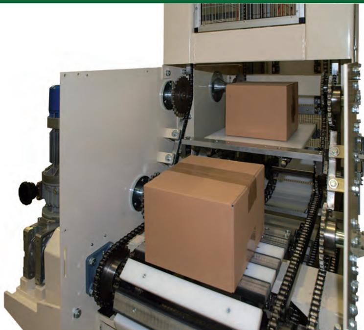
L'elevatore / discensore a ripiani mobili snodati è un componente che permette di alzare o abbassare il flusso di prodotti all'interno di uno stabilimento produttivo al fine di migliorarne la logistica interna. È un trasporto a movimento continuo che solleva o abbassa uno o più prodotti contemporaneamente. La costruzione può essere eseguita in acciaio verniciato o in acciaio inox.
