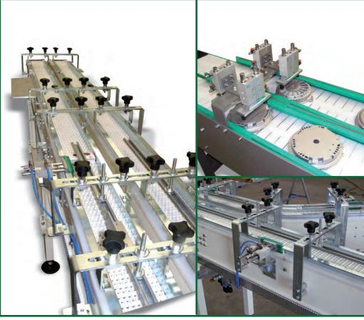
L'innesto motorizzato a scalare è un tipo di trasporto il cui impiego è necessario per riunire 2 flussi di prodotto aventi alte produzioni in uno unico.
