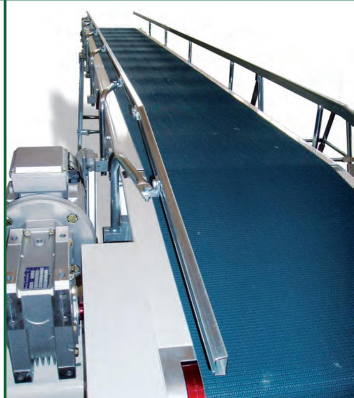
Моторизованные конвейерные ленты могут иметь прямую моторизацию (ключом на валу) или возвращение средств моторизации или звездочки и шкивы и ремни. Может иметь различные типы автоматизации: в концевой части, центральной части, дуги решения и т.д. ...
