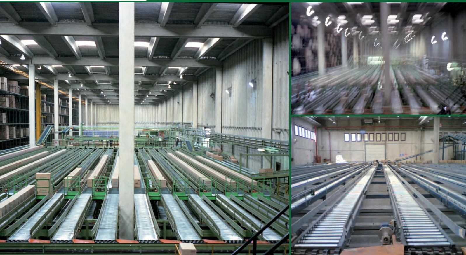
Хранение конвейеры могут иметь диаметр ролика и шаг различного типа в зависимости типа обработки продукта, от минимального  $\varnothing 32$  мм до  $\varnothing 50$  мм максимальная.
