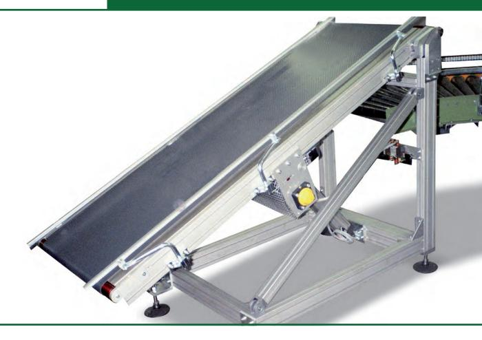
Ограниченный траверс системы для конвейеров позволяют объединять в поток продукта из различных уровня на том же уровне или потока продукта из того же уровня в другом уровне.
