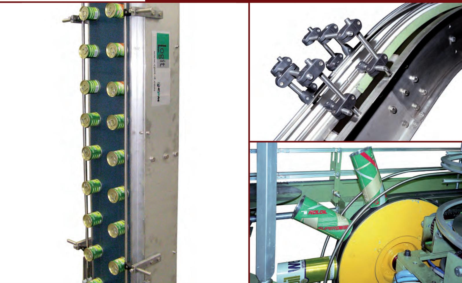
El elevador magnético es un componente que permite elevar el flujo de productos adentro de una planta de producción con el fin de mejorar la logística interna. Es un transporte de movimiento continuo que sube uno o más productos de forma simultánea. La construcción puede llevarse a cabo en acero pintado o de acero inoxidable o aluminio.
