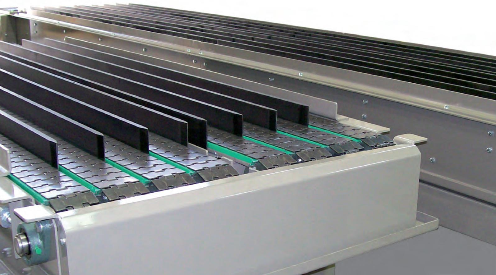
I trasportatori a piastre possiedono larghezze utili fisse scelte in relazione al prodotto movimentato. I trasportatori a piastre possono avere la motorizzazione diretta (calettata sull'albero) o di rimando tramite pignoni e catena o tramite pulegge e cinghie. Possono avere svariate tipologie di motorizzazione: all'estremità, ad arco ecc.
