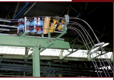
I twist sono collegamenti tra trasportatori, sono realizzati in tondini di acciaio inox di diversi diametri e possono, durante il trasferimento ruotare il prodotto in senso orario o antiorario di 90° oppure ribaltare il prodotto di 180°.
