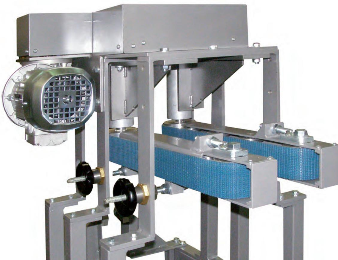
I Dosatori a doppio nastro motorizzato sono componenti atti a cadenziare il flusso di prodotti provenienti da una linea di trasporto verso una macchina automatica la quale può, ad esempio, ricevere il materiale solo con una certa distanza tra loro.
