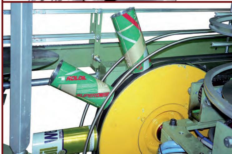
L'elevatore magnetico è un componente che permette di alzare il flusso di prodotti all'interno di uno stabilimento produttivo al fine di migliorarne la logistica interna.
