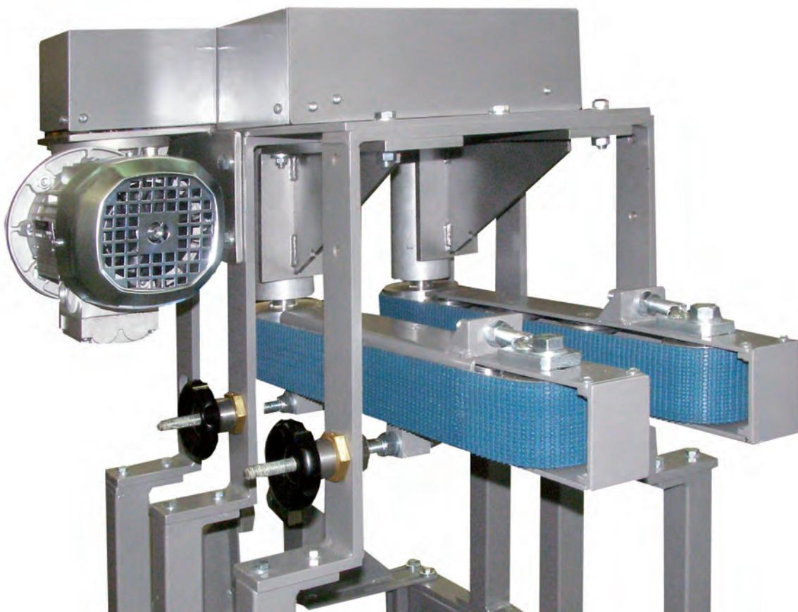
Двухместный прокладками пояса компонент в состоянии темпе потока продукта из других конвейера. Случай для этого приложения, например, механизм, который нуждается расстояние между устройством и другими продукта.
