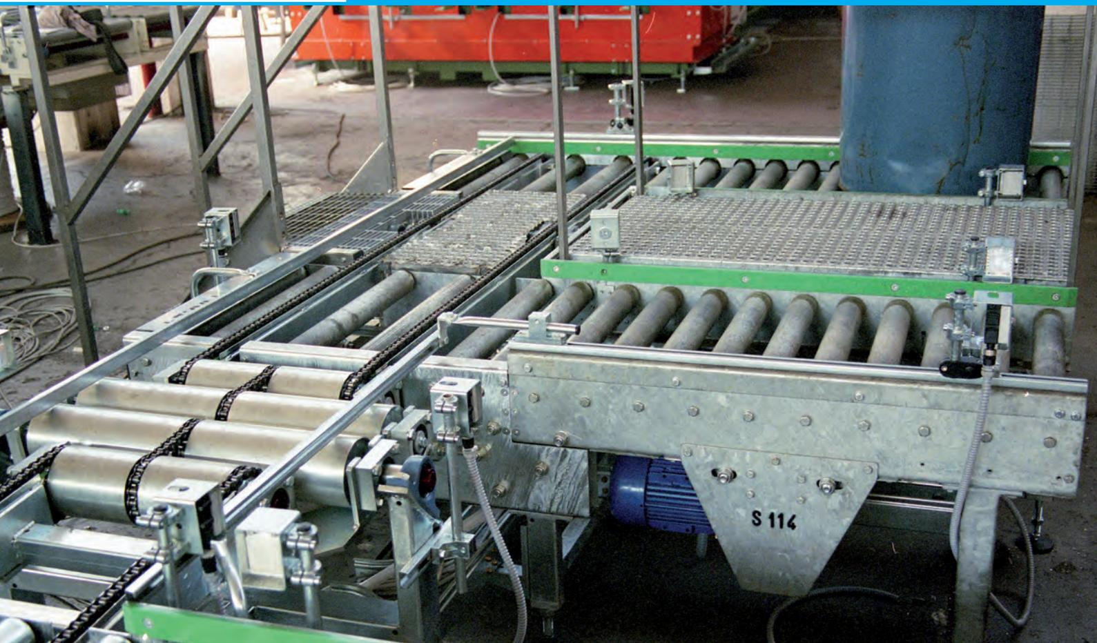
Los transportadores de rodillos neutrales pueden tener rodillos con diferentes diámetros y pasos en relación con el tipo de producto movimentado, desde un mínimo de  $\varnothing 50$  mm a un máximo de  $\varnothing 76$  mm.
