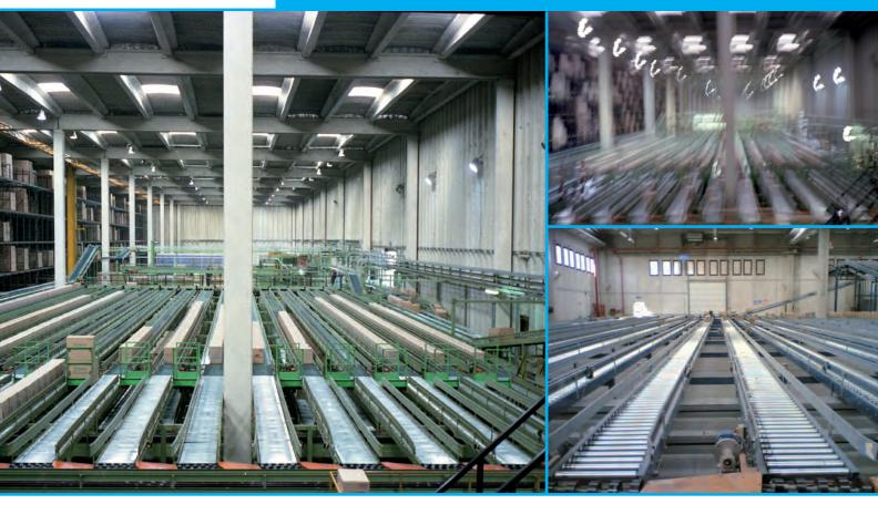
Los transportadores de rodillos pueden tener rodillos con diferentes diámetros y pasos en relación con el tipo de producto manipulado, desde un mínimo de Ø50 mm a un máximo de Ø60 mm.
