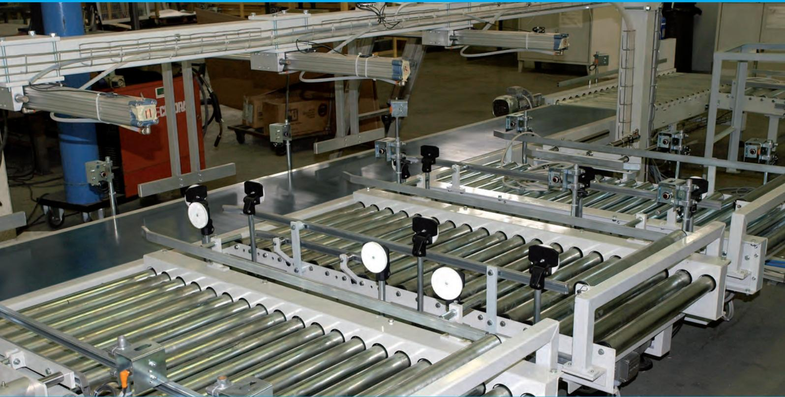
El desviador ortogonal puede ser operado electro-mecánicamente o electro-neumáticamente. Su función es la de trasladar lateralmente (a 90 °) el flujo total o parcial de los productos que llegan de una línea. El cinematismo puede ser superior o inferior al flujo en relación con el tipo de transporte donde es necesario instalar el eyector.
