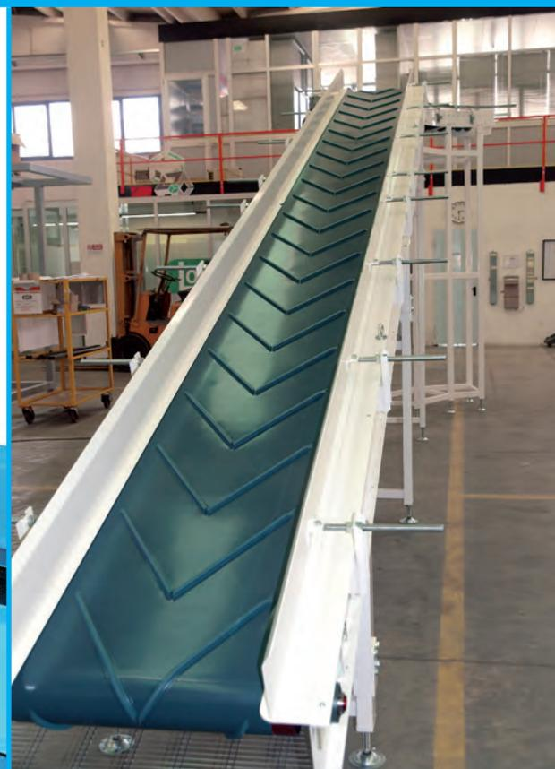
I trasportatori a nastro motorizzato possono avere la motorizzazione diretta (calettata sull'albero) o di rimando tramite pignoni e catena o tramite pulegge e cinghie. Possono avere svariate tipologie di motorizzazione: all'estremità, centrali, ad arco ecc.
