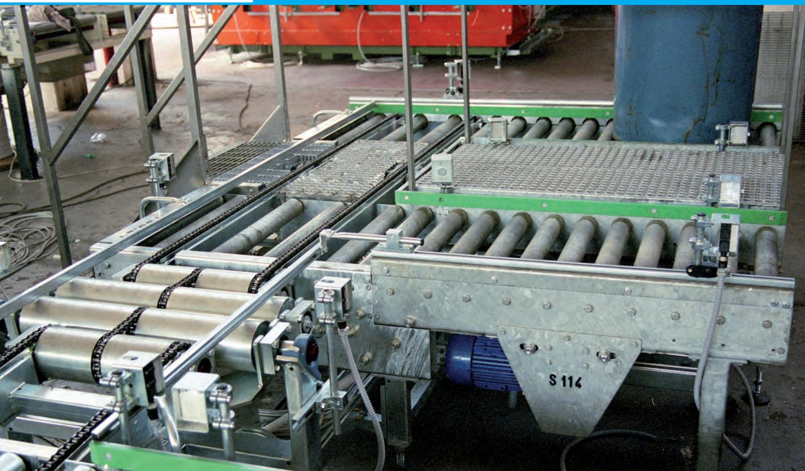
I trasportatori a rulli possono avere rulli di diametri e passi differenti in relazione al tipo di prodotto movimentato – da un minimo di D. 50 ad un massimo di D. 76mm
