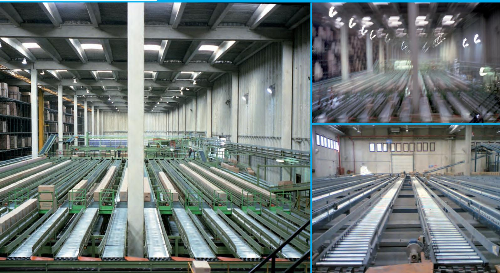
I trasportatori a rulli possono avere rulli di diametri e passi differenti in relazione al tipo di prodotto movimentato – da un minimo di D. 50 ad un massimo di D. 60mm
