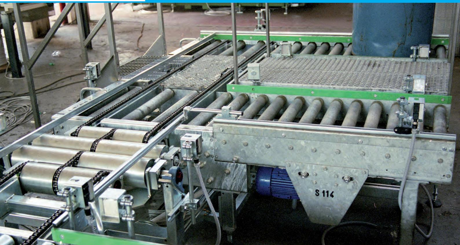
Ожидания рольганги может иметь диаметр ролика и шаг различного типа в зависимости типа обработки продукта, от минимального  $\varnothing 50$  мм до  $\varnothing 76$  мм максимальная.
