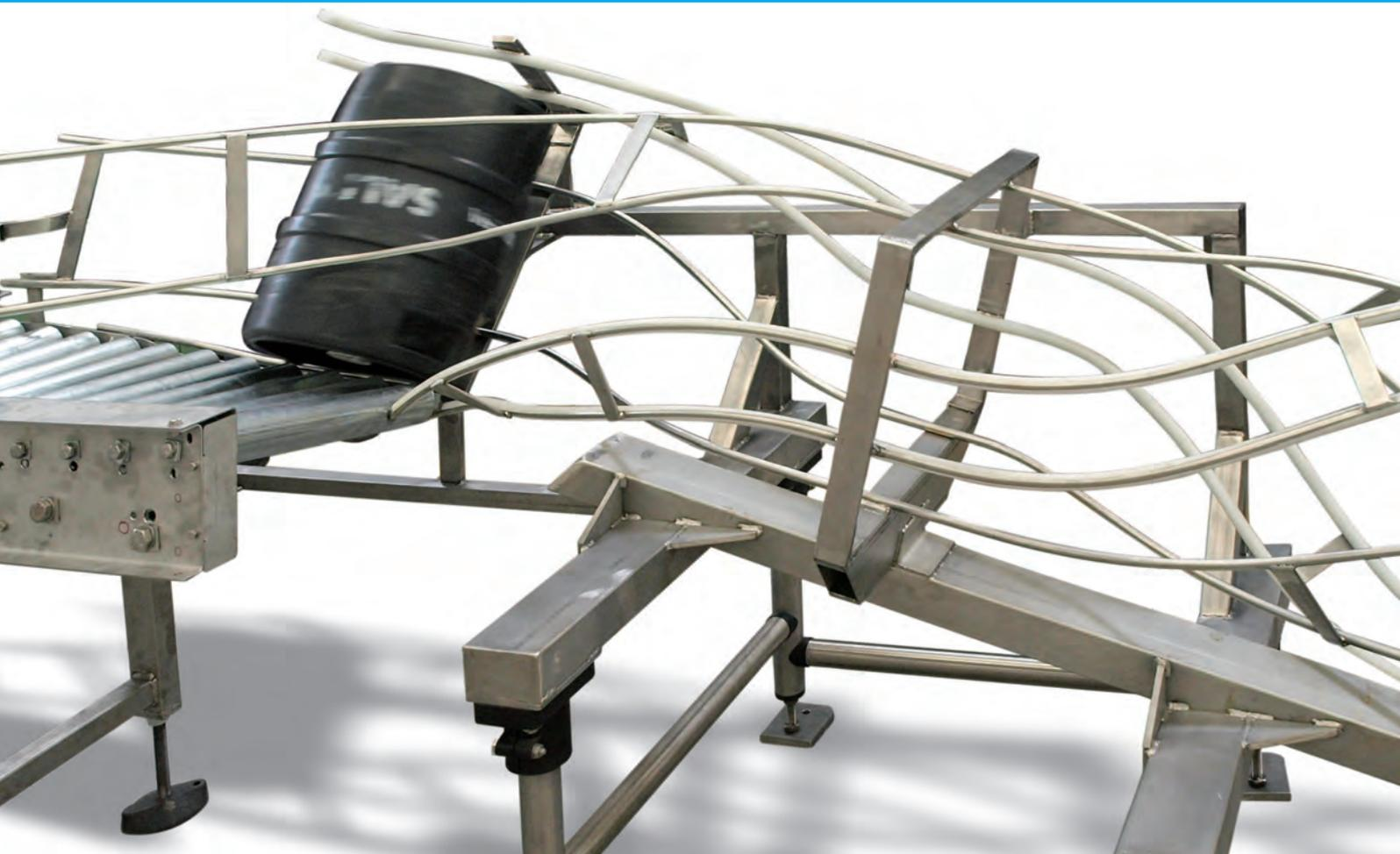
Крыловатости конвейера ссылка, сделанная из нержавеющей стальной стержень с различным диаметром. Они могут вращаться продукт по часовой стрелке или против часовой стрелки на 90 ° или 180 °.
