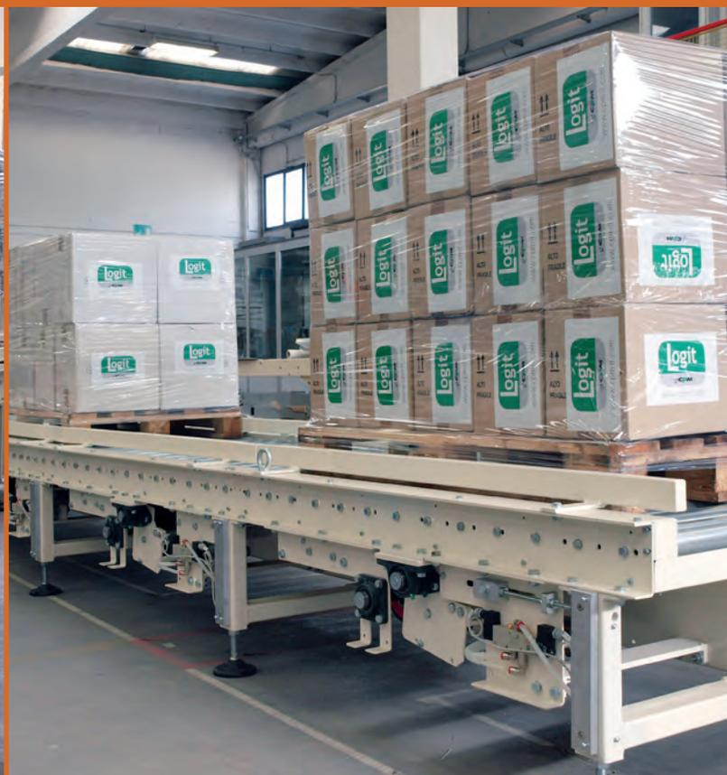
El sistema "Acu Pallet" responde a la necesidad de acumular paletas en modo "paso paso" manejando hasta 10 estaciones accionadas por un solo motor.
