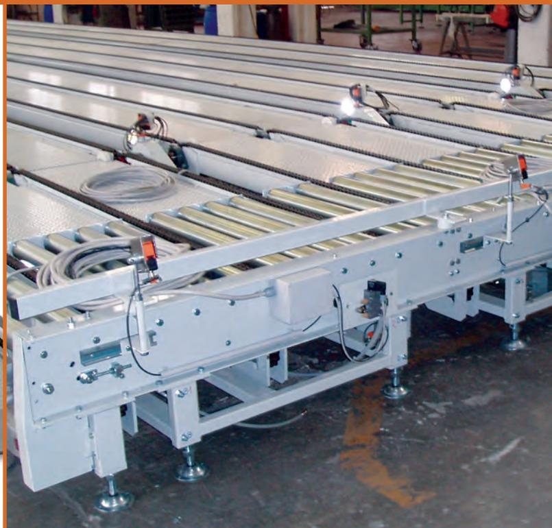
El desviador ortogonal puede ser operado electro-mecánicamente o electro-neumáticamente. Su uso es trasladar lateralmente (a 90 °) del flujo total o parcial de los productos que llegan de una línea. El cinematismo de elevación puede ser a estante, de palancas o basculante en relación con el tipo de producto a transferir.
