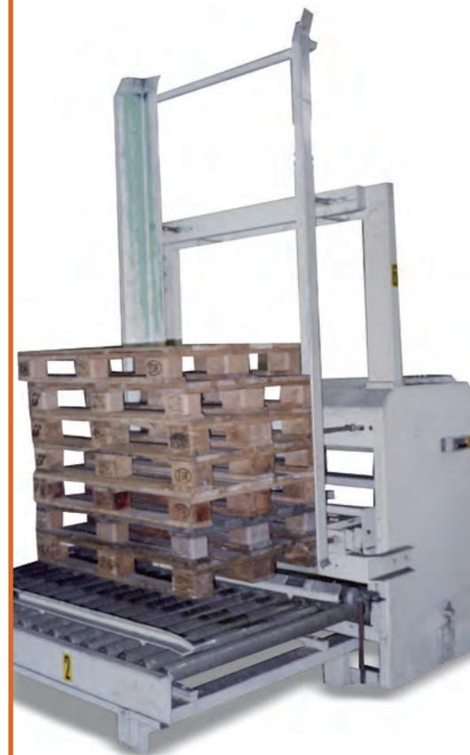
El uso del apilador/desapilador es precisamente de apilar y desempilar pilas de paletas vacías para suministrar a un paletizador.
