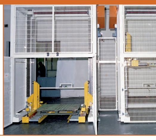
El elevador/discensor de plataforma es un componente que permite aumentar o disminuir el flujo de productos en una planta de producción con el fin de mejorar la logística interna.
