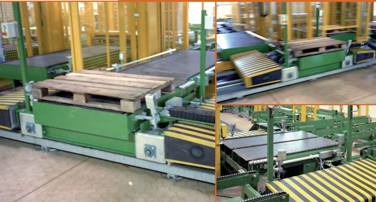
L'impiego della navetta è quello di collegare più linee di trasporto (ad esempio in uscita ai palettizzatori) ad un unico collettore (ad esempio ad una linea di avvolgitura pallet) senza modificare il fronte marcia del prodotto stesso.
