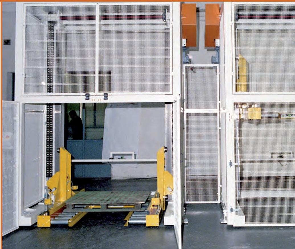
L'elevatore / discensore a piattaforma è un componente che permette di alzare o abbassare il flusso di prodotti all'interno di uno stabilimento produttivo al fine di migliorarne la logistica interna. È un trasporto a movimento alternato che solleva o abbassa uno o più prodotti contemporaneamente. La costruzione può essere eseguita in acciaio verniciato o in acciaio inox.
