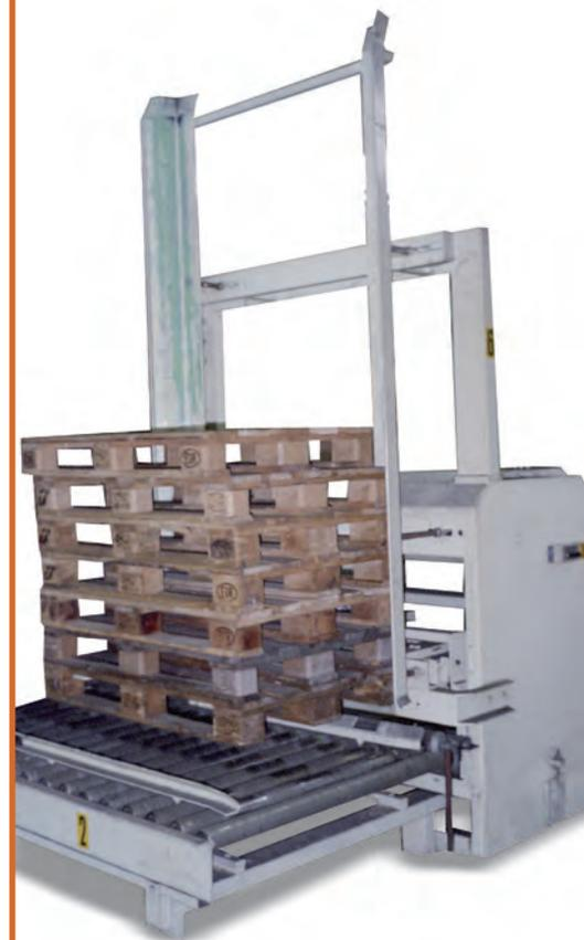
L'impiego degli impilatori / deimpilatori è quello appunto di impilare o deimpilare pile di pallet vuoti ad esempio in asservimento ad un palettizzatore.
